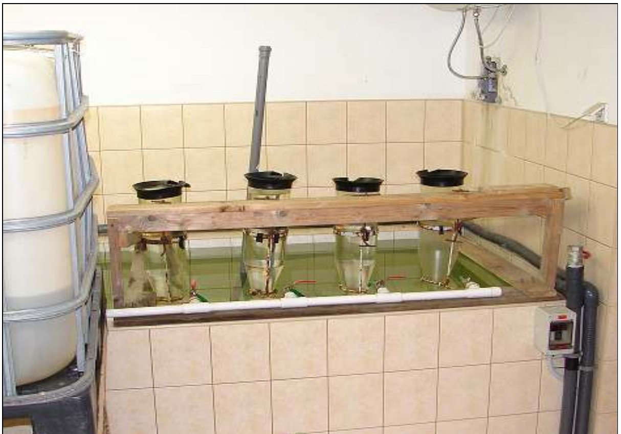
24 pav. Vienne iš baseinėlių sumontuoti Veiso aparatai
