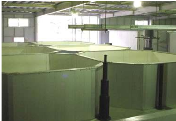
7 pav. Aquaoptima firmos (Norvegija) 200 m 3 talpos auginimo rezervuaras ECO-TANK10 ( http://www.aquaoptima.com )
